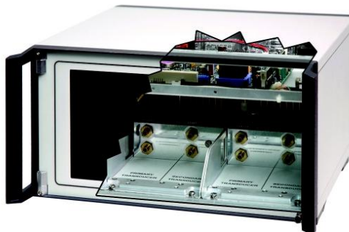
Jeden kalibrator APC600 – dwa kanały, cztery przetworniki, osiem zakresów
